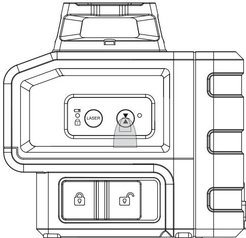
Remarque: lorsque vous activez le mode impulsion, vous pouvez utiliser un récepteur laser (non inclus) pour effectuer un nivelingement sur de longues distances ou lorsque les faisceaux laser ne sont pas visibles
