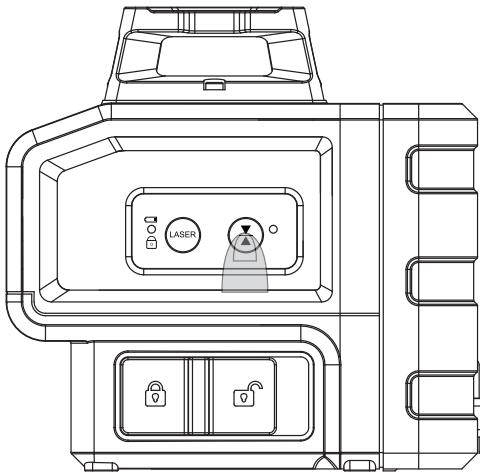
En el modo de pulsado, puede el nivel láser KT360B equipado con el receptor láser (no incluido) para realizar la nivelación a largas distancias o cuando los rayos láser no son visibles.
